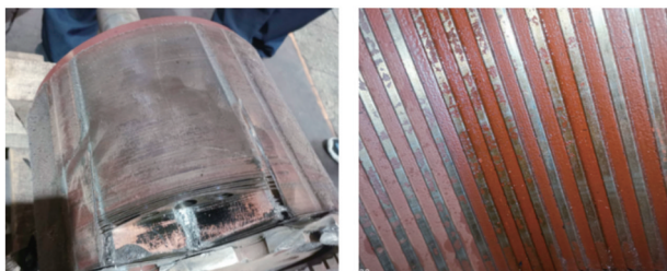
图1 永磁电机失磁后转子和定子状态
